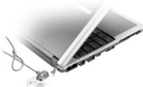
**AVISO:** antes de comprar un dispositivo contra robo, asegúrese de que encajará en la ranura del cable de seguridad del equipo.
