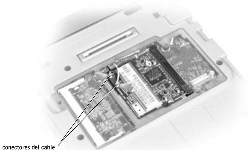
**11** Baje la minitarjeta PCI hacia las lengüetas interiores hasta que forme un ángulo de 20-grados aproximadamente.
