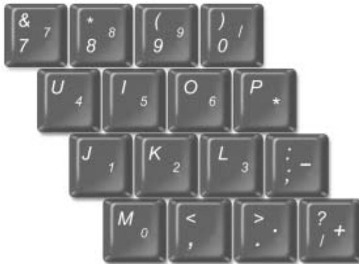
El teclado numérico funciona como el teclado numérico de un teclado externo. Cada tecla del teclado numérico tiene varias funciones.
