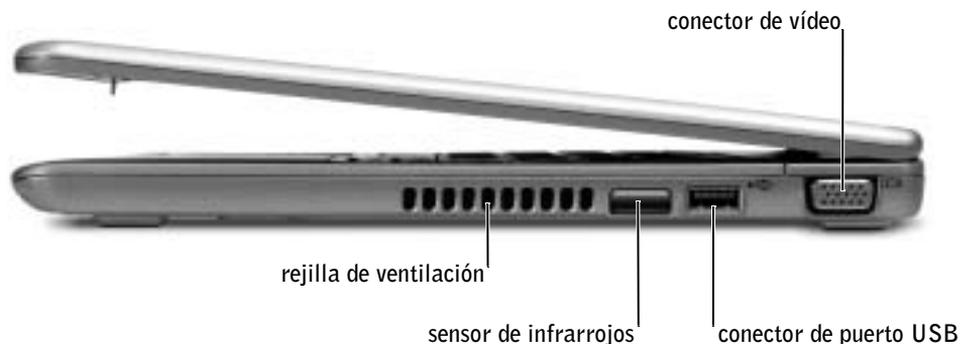
**SENSOR DE INFRARROJOS** — Permite transferir archivos del equipo a otro dispositivo compatible con infrarrojos sin utilizar conexiones de cables.
